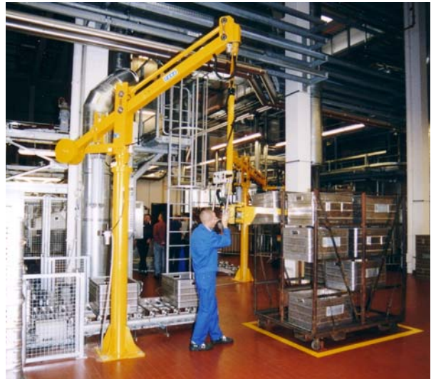
Bis zu 60 kg wiegen die Kisten, mit denen die Cellasto-Bauteile bei der BASF-Tochter Elastogran entlang der Prozesskette bewegt werden.
