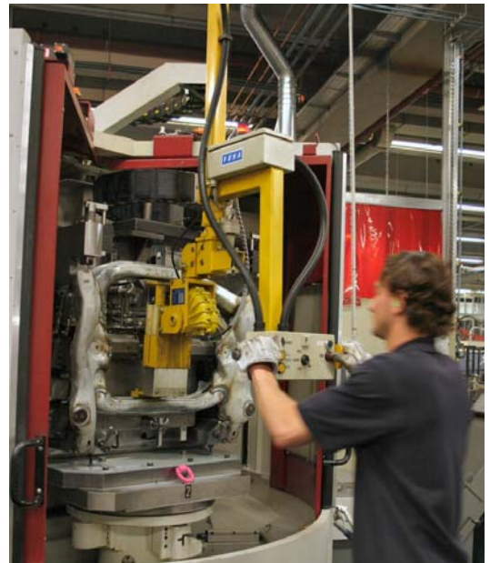
Ein 20 kg schwerer Integralträger wird mit dem Handhabungsgerät in rund 150 cm Höhe in das Bearbeitungszentrum eingelegt.
