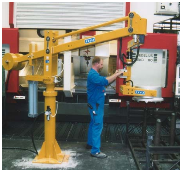
Im Gegensatz zum Kran lassen sich mit Manipulatoren Lasten auch von der Seite in Bearbeitungsmaschinen einlegen – präzise und schnell.
