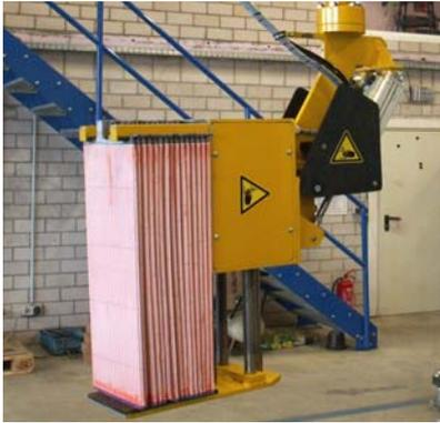
Bisher mussten diese 45 kg schweren Bleiplatten einzeln aus einem Transportgestell gegriffen, geschwenkt und dann abgelegt werden. Mit dem neuen Manipulator können nun 15 Platten auf einmal gehoben werden – von nur einem Mitarbeiter.
