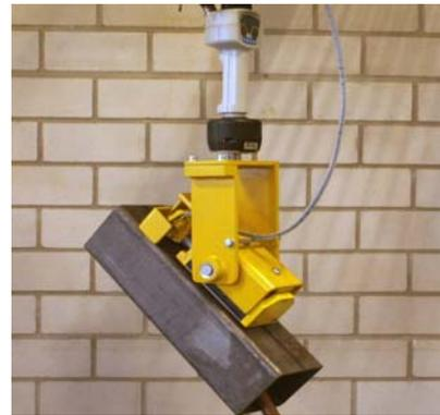
Mit dieser Handling-Lösung werden bis zu 90 kg schwere Stahlteile mittels eines pneumatisch betätigten Magnetgreifers in eine Werkzeugmaschine eingelegt. Der an einem Seillift befestigte Greifer ist dabei beweglich aufgehängt, um sich optimal an die konische Form der Bauteile anzupassen.
