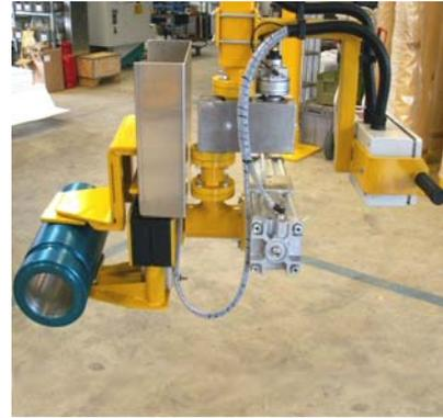
Bei dieser Anwendung werden Zylinder mit verschiedenen Durchmessern gegriffen und gewendet. Die bis zu 80 kg schweren Teile werden von dem Parallelgreifer vertikal aufgenommen und können mit dem Manipulator um bis zu 180° gedreht werden.
