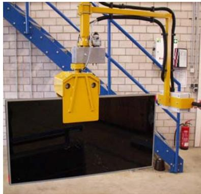
Hier werden fehlerhafte Scheiben für Solaranlagen zum Recycling in Container gehoben. Der kraftschlüssige Greifer fasst sechs Scheiben auf einmal, mit dem Manipulator wird die 60 kg-Last mühelos über die Containerwand gehoben. Auch die Gefahr von Schnittverletzungen wird so minimiert.
