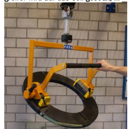
... mit einer einfachen Hebelbewegung manuell magnetisiert ...
