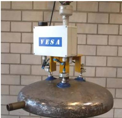
Mit Hilfe eines Vakuumsaugers lassen sich 20 kg schwere Klöpperböden mit einem Durchmesser von bis zu 700 mm aus einer Gitterbox heben und in eine Schweißvorrichtung legen. Die Aufsetzautomatik mit Handkraftsteuerung ermöglicht dabei eine „knopf- und schalterlose“ Bedienung.
