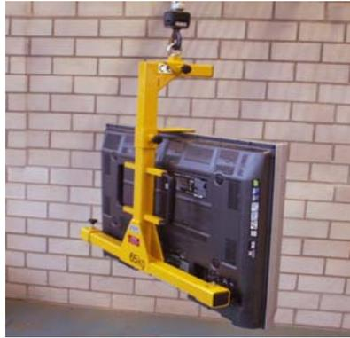
Für das Handling von 65 kg schweren Fernsehern wurde diese kostengünstige mechanische Lastaufnahme entwickelt: Sie nutzt die Griffschalen des TV-Gerätes, um es aus der Transportverpackung zu heben. Zuvor waren für diese Arbeit zwei Mitarbeiter nötig.
