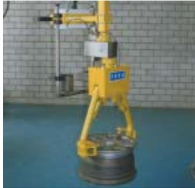
50 kg schwere Felgenrohlinge werden von einem Förderband auf ein Dorngestell gesetzt. Früher wurde die Arbeit manuell durchgeführt. Inzwischen sind schon mehr als 10 dieser Manipulatoren dafür im Einsatz.
