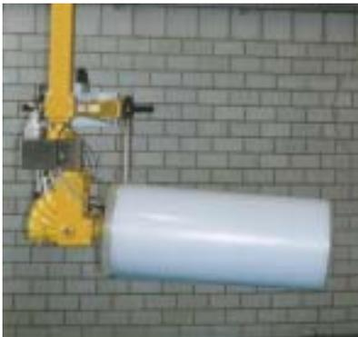
Bis zu 60 kg schwere Rollen mit Folie verschiedener Abmessungen werden von innen gegriffen. Gespannt wird dabei über die Papphülse. Die liegenden Rollen werden mit der Lastaufnahme aufgenommen, um 90° geschwenkt und stehend auf eine Palette gesetzt.
