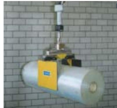
Hier werden bis zu 60 kg schwere Folienrollen verschiedenen Formats von außen gegriffen. Bei dem rein mechanischen Greifer ist nur eine Backe abgekantet, die andere glatt. So können die Rollen sehr eng – die Greiferbacken sind nur 3 mm dick – nebeneinander abgelegt werden.
