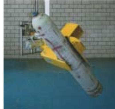
Die an einer Hubachse montierten Greifer fixieren bis zu 150 kg schwere Gasflaschen kraftschlüssig, eine Gummierung verhindert Beschädigungen. Die Flaschen lassen sich so zu Prüfzwecken um 180° drehen.
