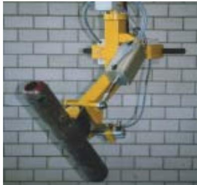
Besonderheit hier ist der pneumatisch betätigte Permanentmagnet: Gegenüber einem Elektromagnet ist der Steuerungsaufwand gering und ein Stromausfall problemlos. Die 50 kg schweren Bauteile lassen sich so sicher um 135° kippen und in eine Prüfeinrichtung setzen.
